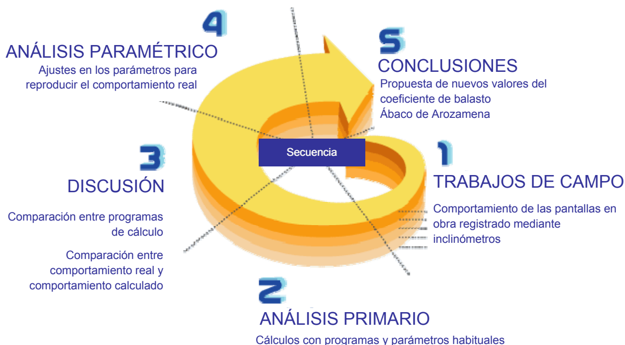
Figura 1. Secuencia de trabajos realizados
